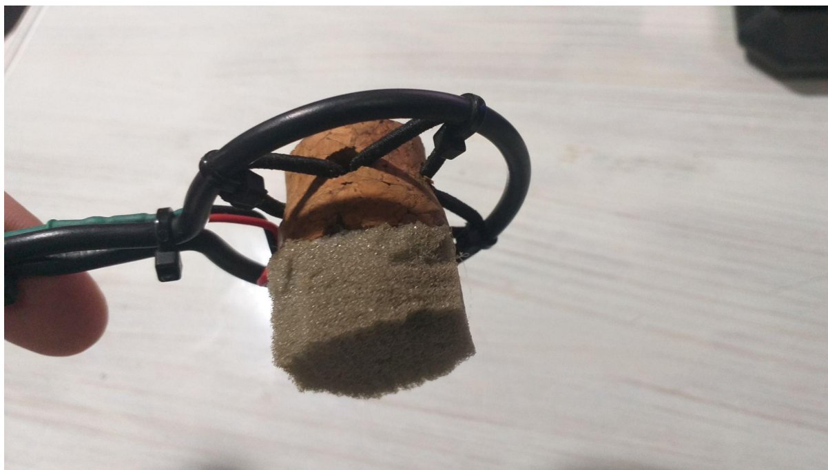
FIGURAS 3 E 4: Estrutura de suporte do microfone piezoelétrico. Fonte: arquivo pessoal.
