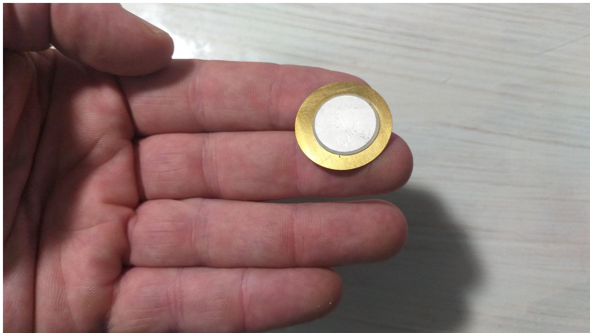
FIGURA 3: Um microfone piezoelétrico. Fonte: arquivo pessoal.
