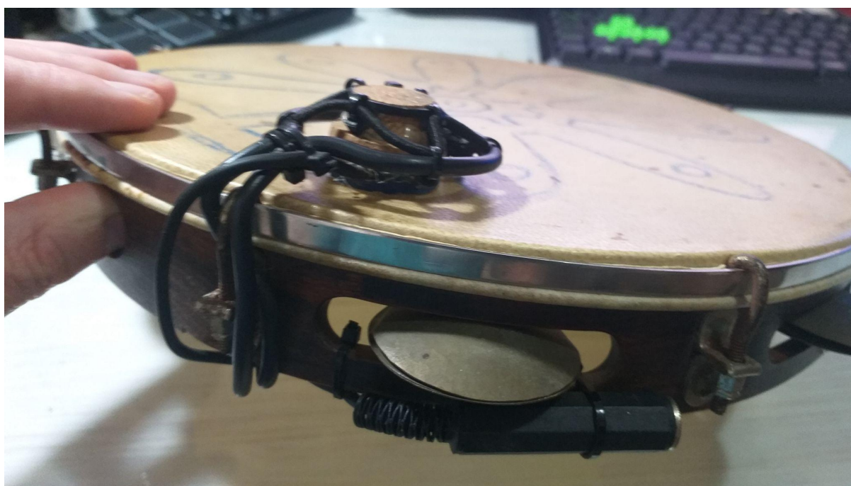
FIGURAS 5 E 6: Sistema de fixação do dispositivo no instrumento. Fonte: arquivo pessoal.
